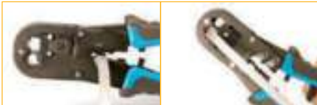
Corte de cables de red
